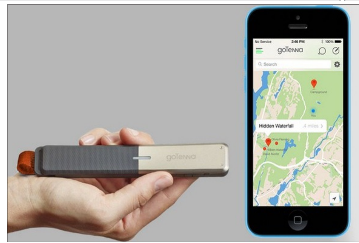
این گجت کوچک می‌تواند کاری کند که حتی وقتی در مناطقی خارج از برد آنتن موبایل هستید هم از گوشی خود استفاده کنید. این دستگاه پس از اتصال به تلفن همراه از طریق بلوتوث، جای آنتن را می‌گیرد و از این راه می‌تواند دریافت و ارسال سیگنال‌ها را تقویت کند.
